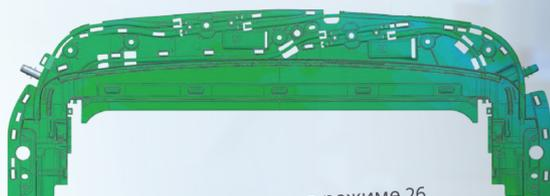
Данные, полученные в режиме 26 лазерных линий. Сравнение с CAD моделью.
